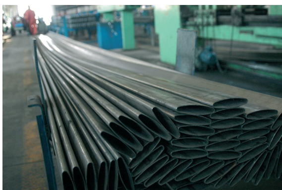
Стальной трубопровод готов к натяжению ребер
