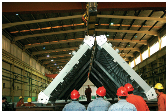
Связки трубных панелей собираются в дельтаобразную форму
